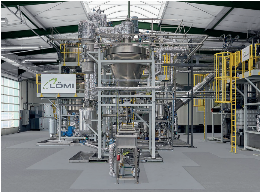
Bild 2. Die Demonstrationsanlage der Lömi GmbH verarbeitet bis zu 25 kg verschiedene Abfallfraktionen pro Stunde. © Lömi
